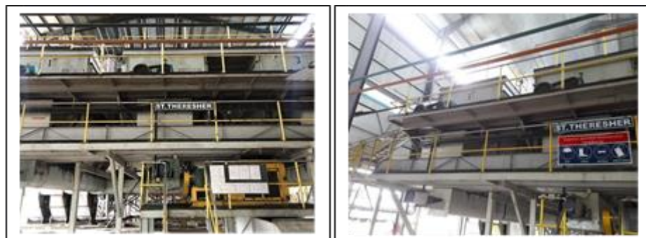
Gambar 5 dan 6. Proses Threshing / penebahan TBS setelah direbus
